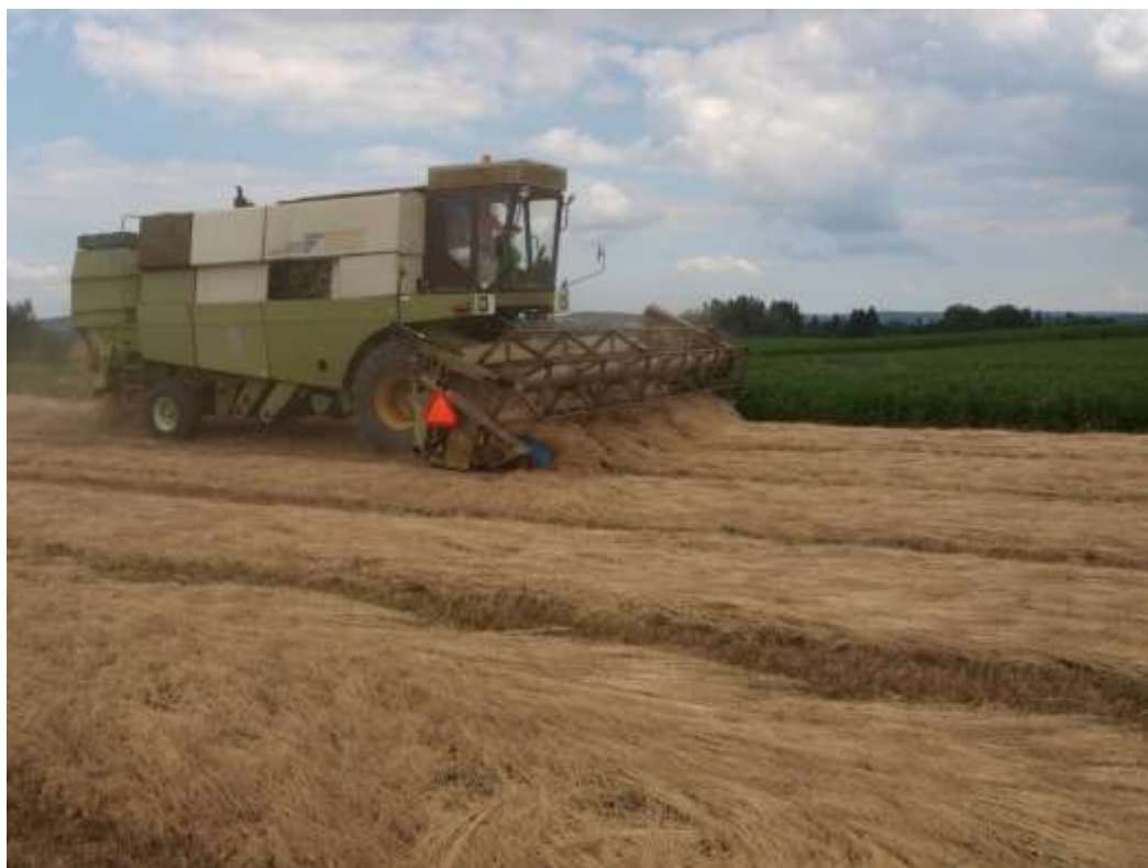
Obr. 14: Využití výkonné mlátičky se sběracím ústrojím na posečeném porostu bez předchozího obracení řádků (Mirošov 9.7.2018) (foto S. Hejduk)
