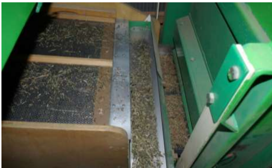
Obr. 17: Čištění osiva kokrhelů na čistící stanici firmy DLF Seeds s.r.o. v Hladkých Životicích (kulatá síta a separace jemných nečistot proudem vzduchu) foto S. Hejduk
